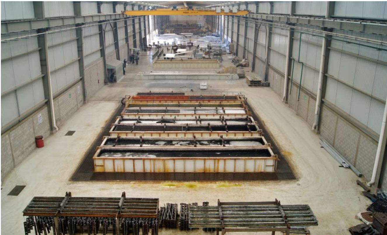
Taller de galvanizado de estructuras
